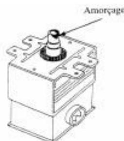
Vérifier d'éventuelles traces d'amorçage sur l'antenne
