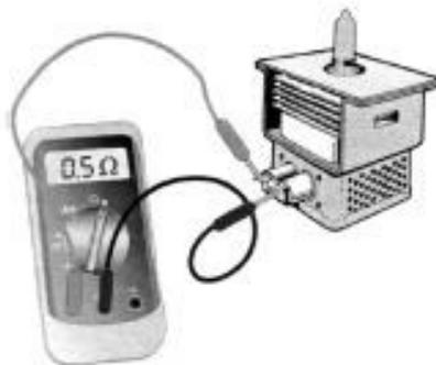
Mesurer à l'ohmmètre la résistance du filament (calibre 200 $\Omega$ )
