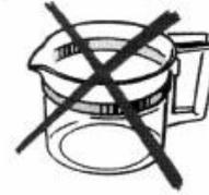
L'introduction de plats métalliques ou de papier aluminium dans l'enceinte entraîne une diminution de son volume et la désadaptation du four (risque de destruction du magnétron par retour d'ondes).
