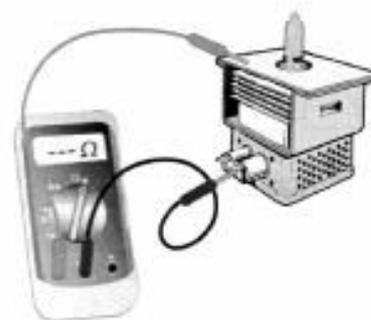
Mesurer à l'ohmmètre (calibre 2 M $\Omega$ ) la résistance d'isolement entre l'anode (masse) et la cathode (une des bornes du filament)
