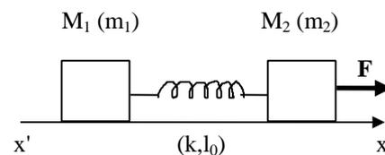
A partir de  $t = 0$ , on exerce sur  $m_2$  une force horizontale constante  $\vec{F} = F \vec{u}_x$ . On note  $x_1(t) = M_{10}M_1$  et  $x_2(t) = M_{20}M_2$ . Déterminer  $x_1(t)$  et  $x_2(t)$ .
