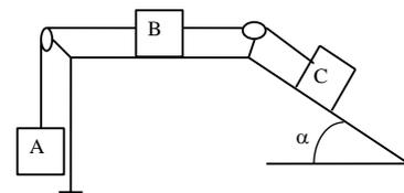
On néglige la masse des fils et on admet que la tension est la même de part et d'autre d'une poulie.
