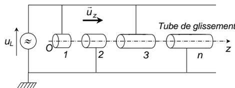
On considère les protons qui pénètrent en O suivant l'axe (Oz) des tubes à l'instant  $t = 0$ , c'est-à-dire lorsque  $u_L = 0$ . On veut que ces protons soient accélérés par la tension maximale  $U_L$  toutes les fois qu'ils passent d'un tube à l'autre. On considérera que la distance entre deux tubes est négligeable par rapport à la longueur des tubes.
