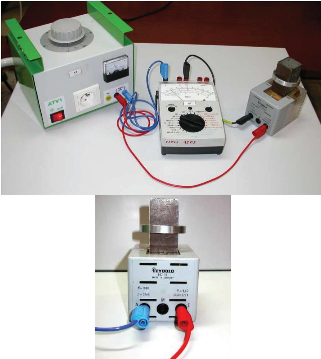
Fig. 1 - Photos du dispositif expérimental (en haut) et observation de l'anneau en lévitation (en bas).
