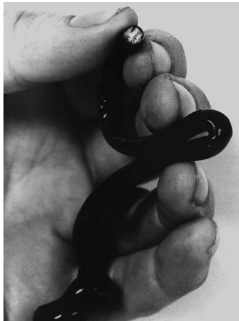
Un faisceau cohérent de fibres optiques de 10 \mu\text{m} : même fortement plié, il transmet une image. (Photo American ACMI Div., American Hospital Supply Corp.)
