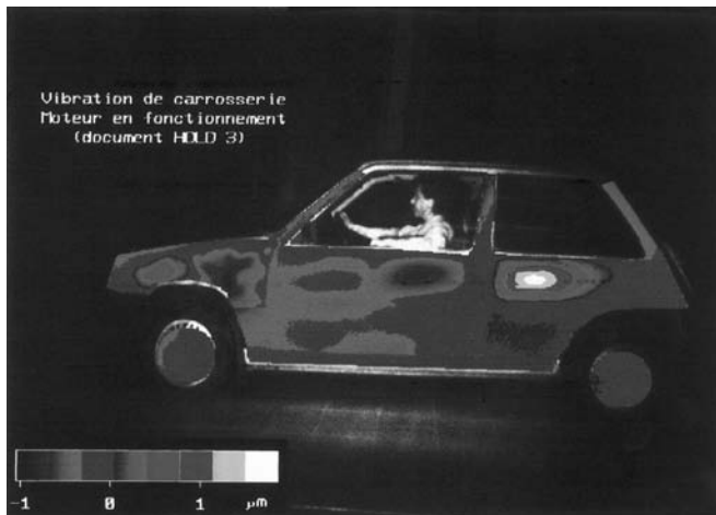
Profil d'ondes stationnaires sur le côté d'une voiture, occasionné par les vibrations de son moteur. L'échelle est en microns, où 1 \mu\text{m} = 10^{-6} \text{ m} . La photo a été réalisée en utilisant une technique holographique (Photo H0LD3/FTPO.)
