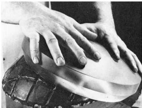
Polissage d'une lentille sphérique. (Photo Optical Society of America.)
