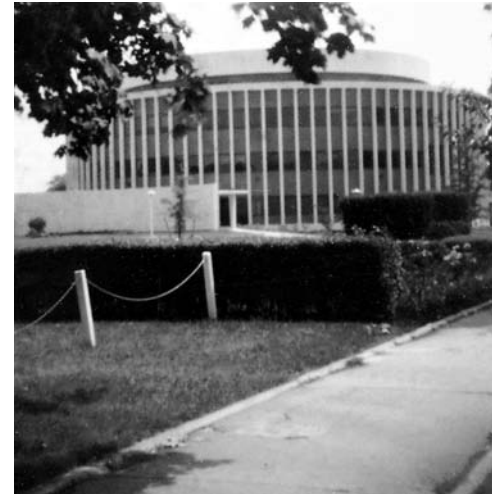
Photographie prise avec un sténopé (Science Building, Adelphi University). Diamètre du trou : 0,5 mm, distance du plan du film : 24 cm, A.S.A. 3000, obturateur vitesse 0,25 s. Notez la profondeur de champ. (Photo E.H.)
