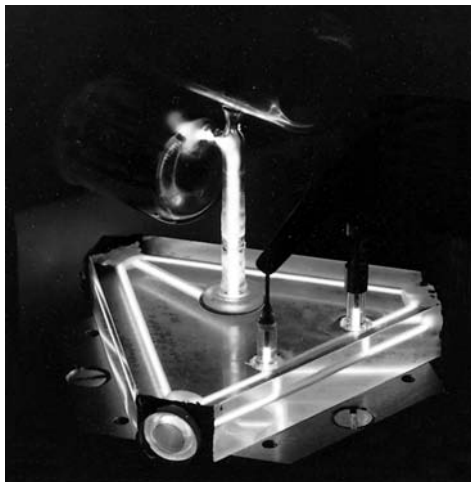
Un des premiers gyrolaser en anneau. (Photo Autonetics, filiale de Boeing North America, Inc.)
