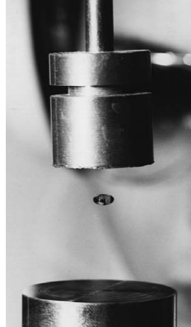
Lévitation ultrasonique. Des ondes ultrasoniques, l'une se propageant vers le haut, et l'autre vers le bas, forment une figure d'ondes stationnaires. Ici, une gouttelette d'eau est suspendue dans une région nodale. (Photo NASA.)
