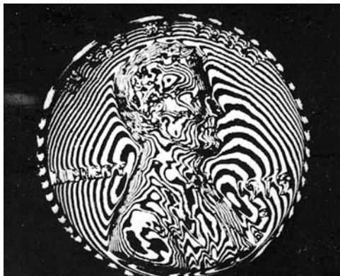
Image interférométrique d'un penny par holographie acoustique. (Photo Holosonics, Inc.)
