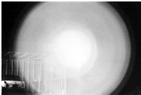
Objectif traité avec une seule couche de MgF_2 . (Photo Optical Coating Laboratory, Inc. Santa Rosa, CA.)
