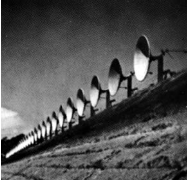
Le radiotélescope interférométrique de l'université de Sydney, en Australie ( N = 32 , \lambda = 21 cm, d = 7 m, diamètre 2 m, extension est-ouest de plus de 2 km).
