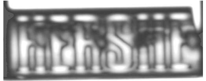
Une photo de barre chocolatée prise en utilisant des rayons T. Les noisettes, qui étaient cachées derrière le chocolat, deviennent visibles par réfraction. (Photo V. Rudd, Picometrix, Inc.)
