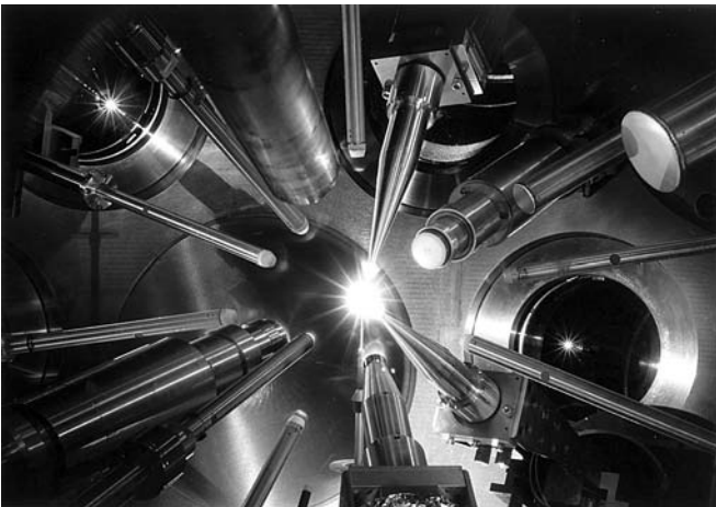
À l'intérieur de la chambre cible du dispositif de fusion par laser LLE. Les réactions de fusion ont lieu dans une petite sphère cible remplie de deutérium/tritium et irradiée par le laser Omega de 30 kJ. (Photo University of Rochester's Laboratory for Laser Energetics, Eugene Kowaluk, Image specialist.)
