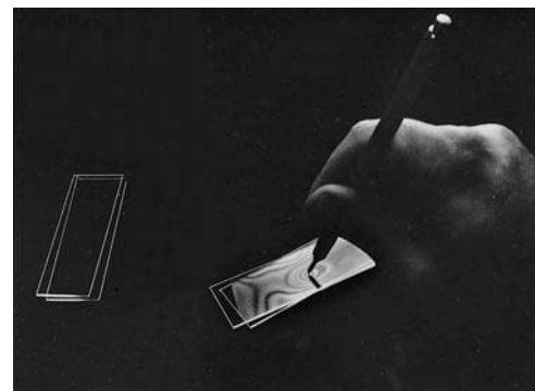
Franges créées par un film d'air entre deux lames de microscope. (Photo E. H.)
