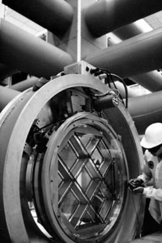
Le convertisseur de fréquence en KDP pour le laser Nova. (Photo Lawrence Livermore National Laboratory.)
