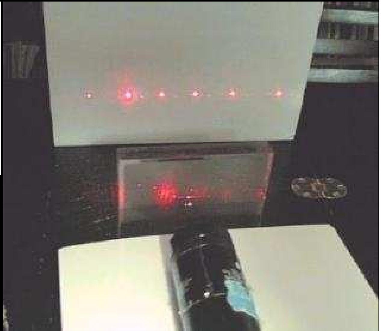
Diffraction par un réseau d'une lumière monochromatique ici un laser
