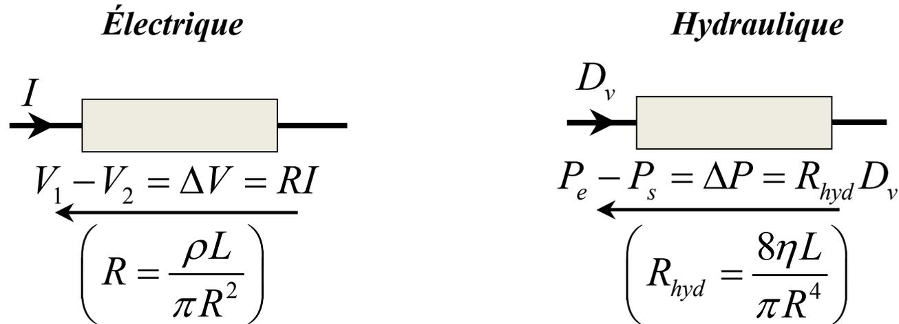
De la même manière qu'en électricité où l'on définit la résistance électrique d'un fil de cuivre de résistivité  $\rho$ , de longueur  $L$  et de rayon  $R$ , parcouru par un courant  $I$  quand la tension à ses bornes est  $V_1 - V_2$  sous la forme ...
