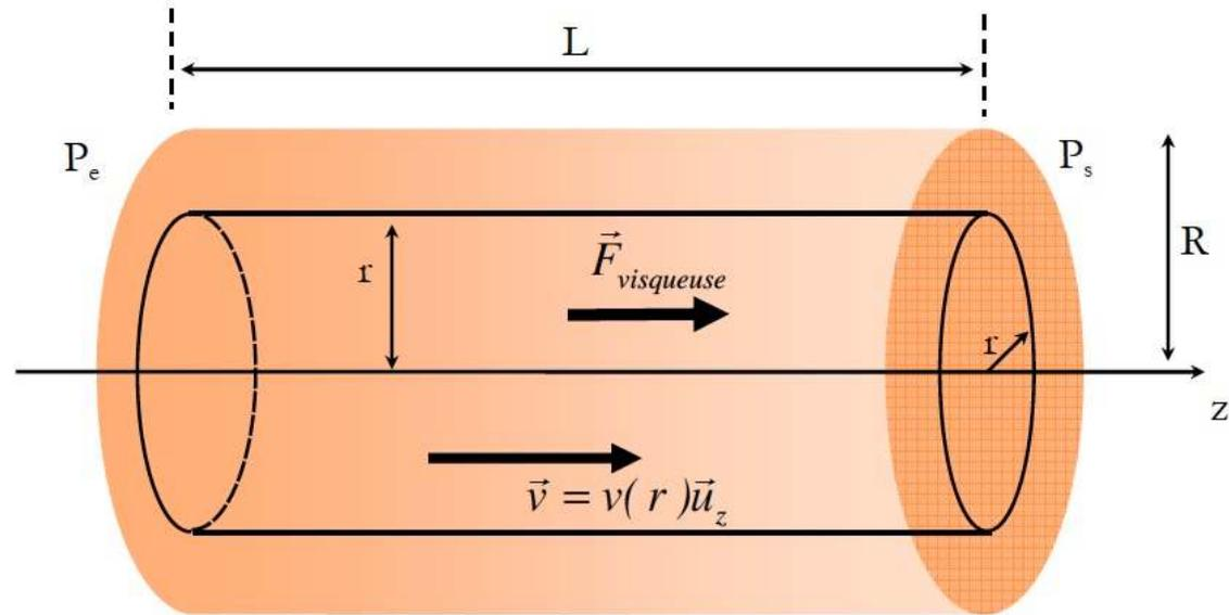
On considère la portion de fluide cylindrique, de rayon  $r$  et de longueur celle de la conduite  $L$ , centrée sur l'axe.
