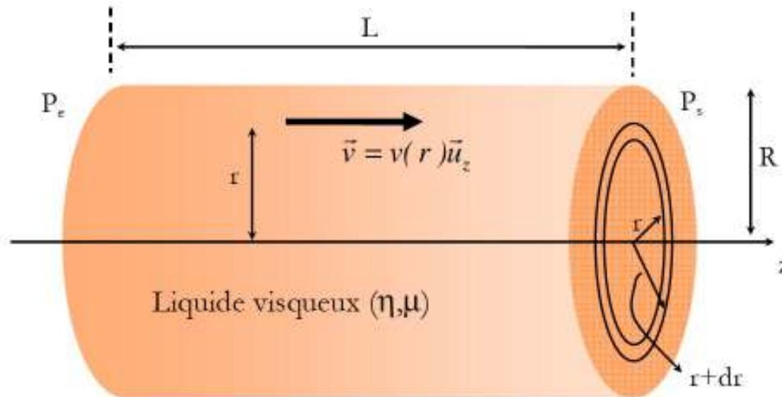
Le débit volumique dans la conduite est le flux du vecteur vitesse à travers une section transverse quelconque, soit, en prenant comme surface élémentaire celle comprise entre deux cercles de rayons  $r$  et  $r+dr$  :
