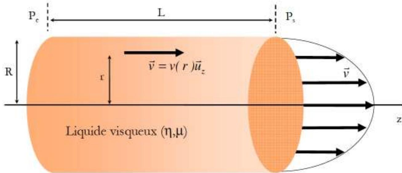
On peut tracer l'allure du profil des vitesses, c'est-à-dire tracer la courbe qui passe par les extrémités des vecteurs vitesses, ces derniers étant dessinés à partir d'un plan  $z=\text{cste}$ .
