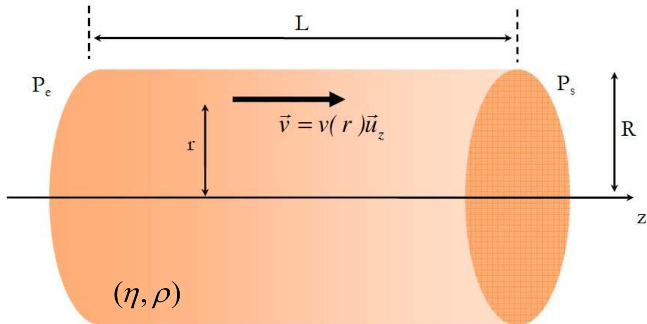
On s'intéresse à l'écoulement d'un fluide visqueux dans une conduite cylindrique horizontale de rayon  $R$  et de longueur  $L$ , en régime stationnaire, c'est-à-dire indépendant du temps.
