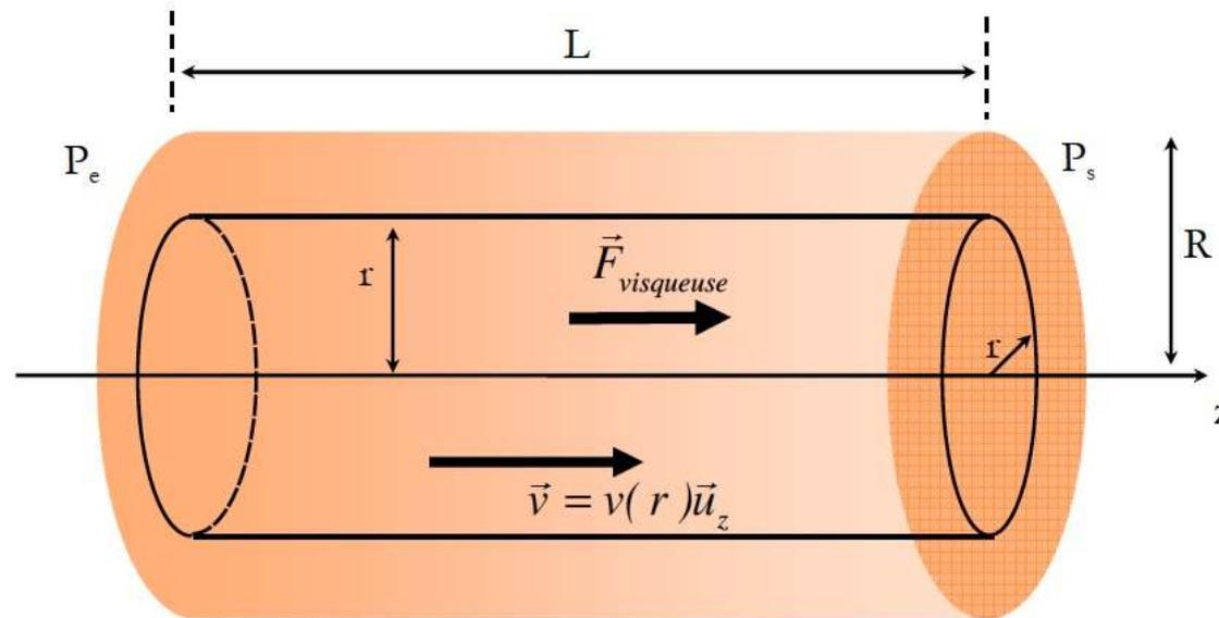
Soit la force de pression en amont,  $\pi r^2 P_e$ , moins la force de pression en aval,  $\pi r^2 P_s$  plus la force de frottement visqueuse  $F$  qui s'exerce sur la surface latérale du cylindre de rayon  $r$  qui est égale à 0 :
