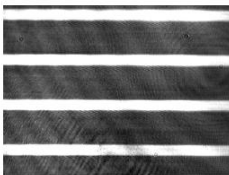
Grille filtrée par une fente verticale de 40\text{ }\mu\text{m}
