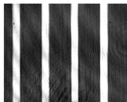
Grille filtrée par une fente horizontale de 70\text{ }\mu\text{m}
