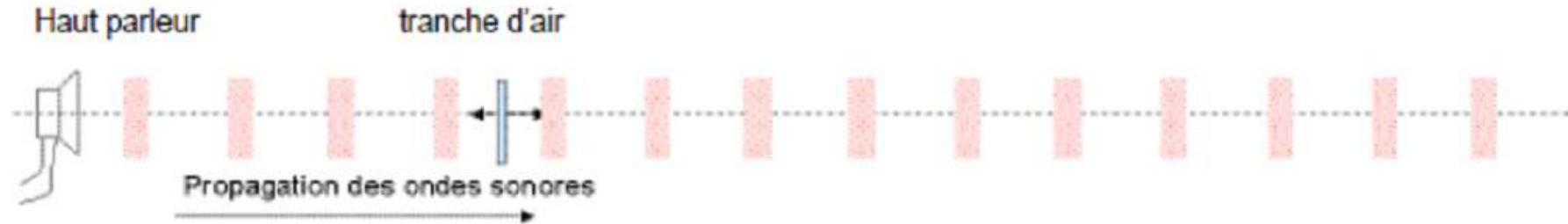
Une onde sonore est une vibration mécanique qui se propage dans un milieu matériel, comme l'air ou un liquide.
